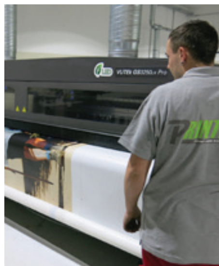
Der EFI VUTEK GS3250Lx Pro druckt auf die Rolle mit 1000 dpi und 12 pl bis zu 110 m 2 /h.
