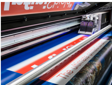
Druck einer Lkw-Plane auf einem EFI VUTEk 32h
