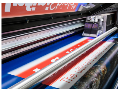
Bâche de camion en cours d'impression sur une imprimante EFI VUTEk 32h.
