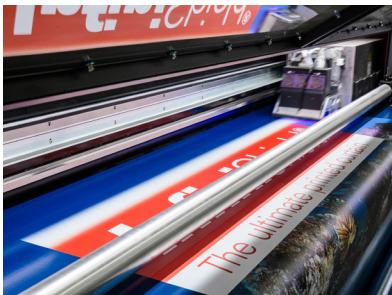
正在 EFI VUTEk 32h 上打印的卡车侧帘
